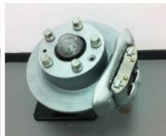
Scheibenbremsen mit 100% wasserdichte Öl gefüllten Radlager
